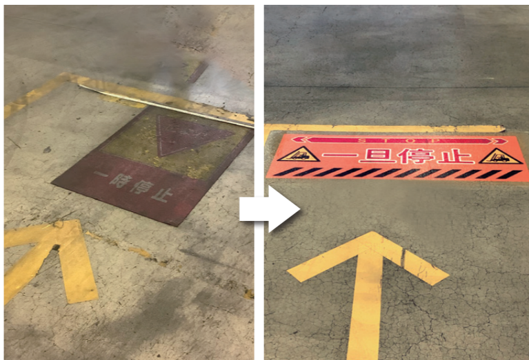
既製品の一時停止シールを貼っていたがサイズ感が違い、すぐに汚れが目立った
